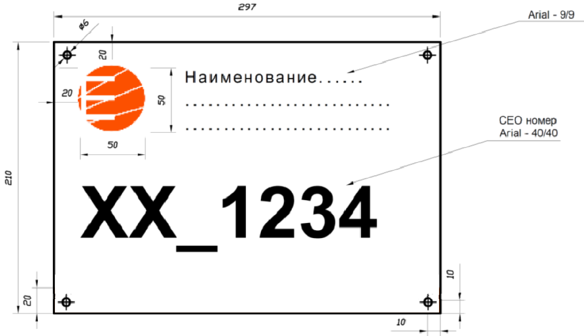
Фигура 1 - Информационна табела за идентификация на трафопост
